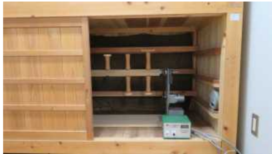
回転装置 漆を厚目に塗った場合は、垂れてくるのを防ぐため、回転させながら乾かします。風呂の中に回転装置を設置し、つく棒を取り付けて使用します。
