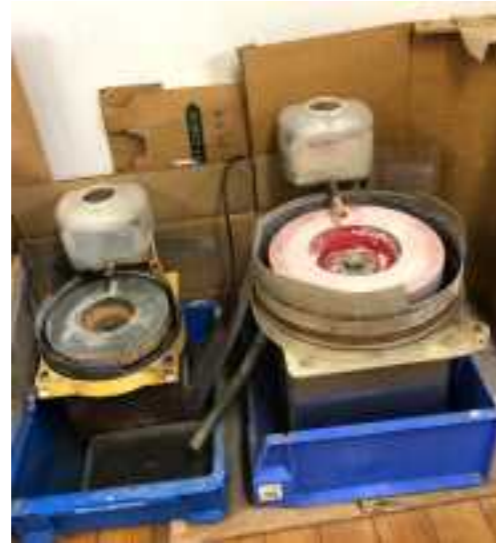
水研ぎグラインダー 水を供給させて冷却しながら刃物を研ぐ際に使用します。
