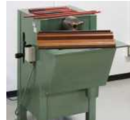
木工ロクロ 丸盆、茶托、椀、茶道具、菓子器等の素地を作成する際に使用します。回転する木材に刃物をあてて削ります。
