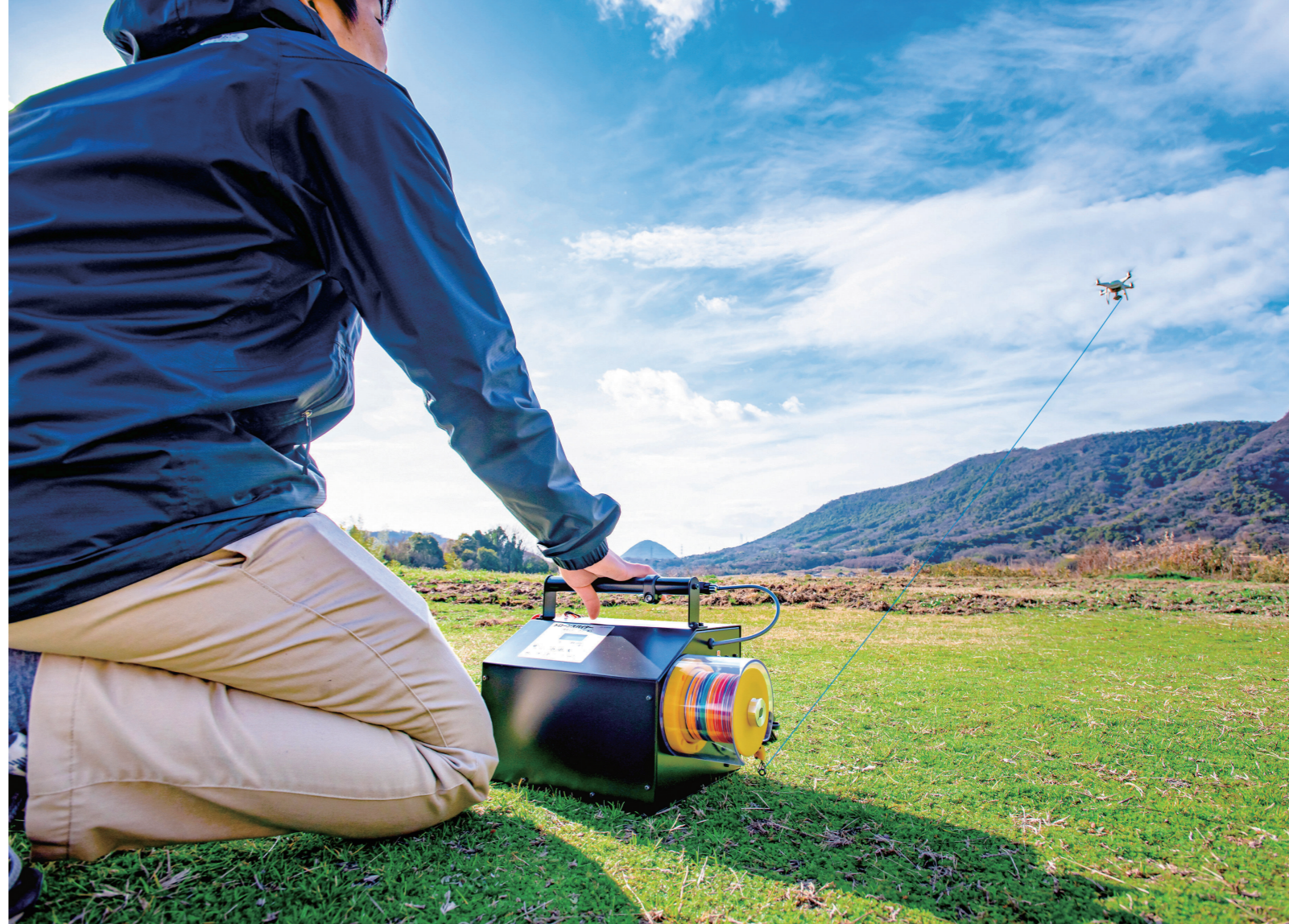
安全なドローン運用をサポートする係留装置「ドローンスパイダー」
