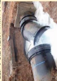
地震による継手離脱(H23東日本大震災)
