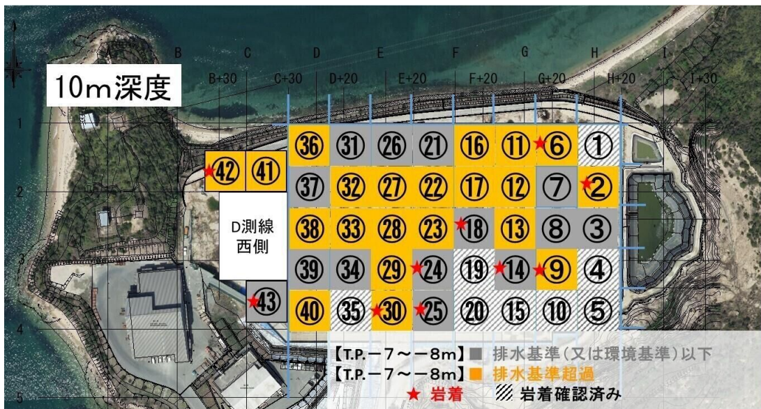
図3-2-3 地下水汚染領域の把握のための調査地点 (概況調査結果、地表から5m深度、地表から10m深度)
