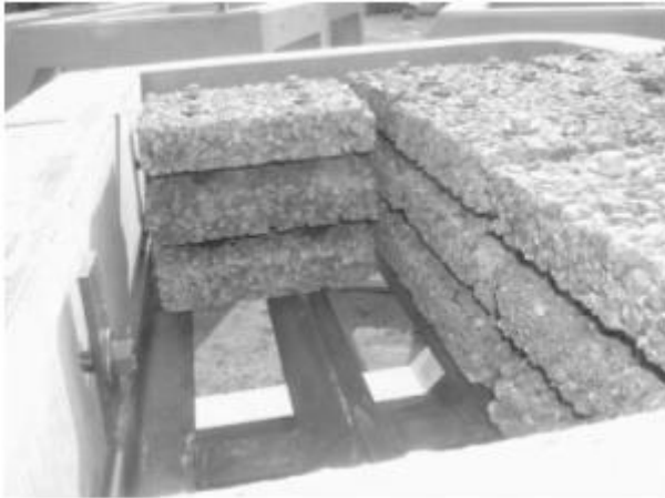
写真 5.5 多孔質体パネル装着状況(3)
