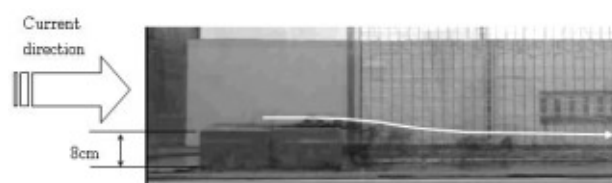
図 2.12 水槽での水理実験での直線状構造物周囲の流れの状況
