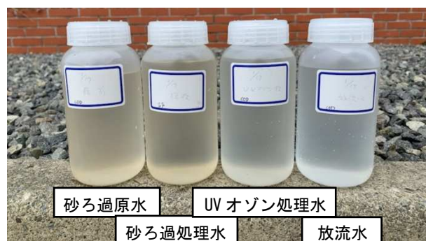
各工程の原水及び処理水
