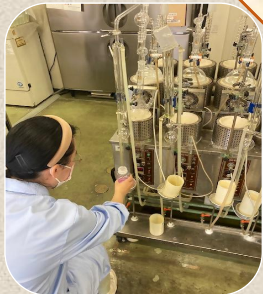
【水蒸気蒸留による前処理作業中】
