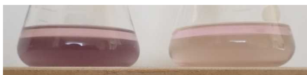
図1 模擬的過酸化物価分析条件下におけるヨウ素デンブンプン反応(左:トウモロコシ由来通常デンブンプン, 右:溶性デンブンプン)
