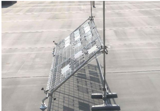
図2 屋外暴露試験の実施状況
