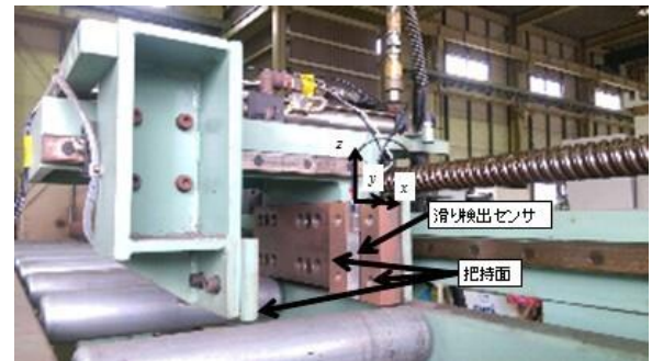
(a) 搬送装置（実機）への取付け状況
