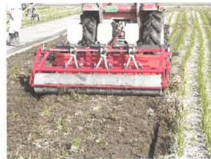
小～中型トラクタ用 (27～35ps適応) 逆転ロータリによる播種
