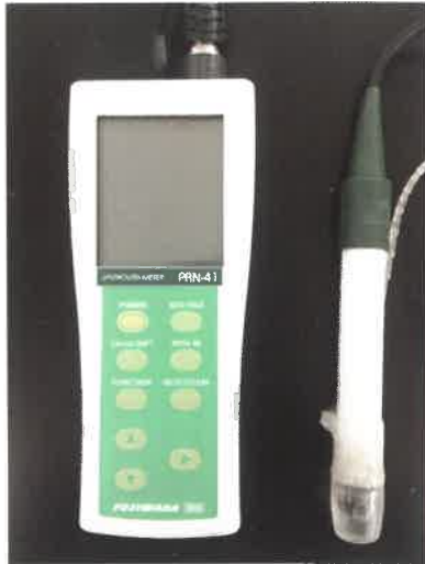
pH 簡易測定用 ポータブル土壌 pH メーター
