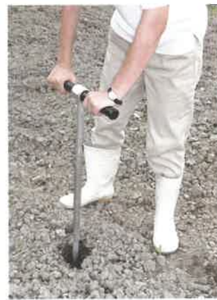
ハンドオーガによる掘削
