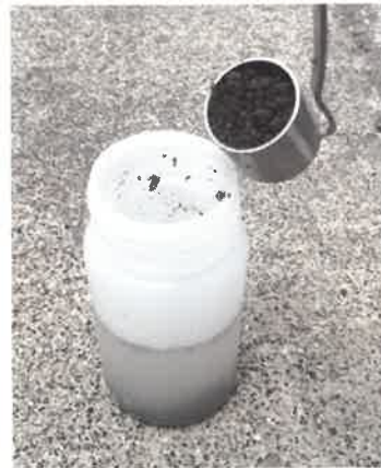
pH 簡易測定用 ポータブル土壌 pH メーター
