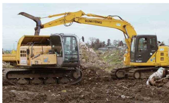
図 4-8 がれきの移動・撤去・分別に使用したアタッチメントとフォーク付きバックホウ
