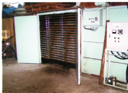
⑦ 台車ごと乾燥機に入れて10~20時間乾燥させます。
