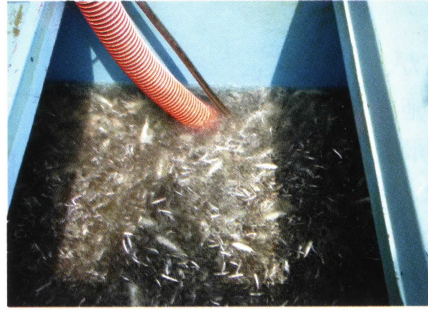
② 船の中からイワシをフィッシュポンプで吸い上げ、加工場へ送ります。
