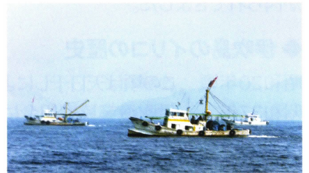
③ 網船の2隻は、一定の間隔を保ちながら平行に進んで網をひきます。30分から1時間ひき、網をあげます。
