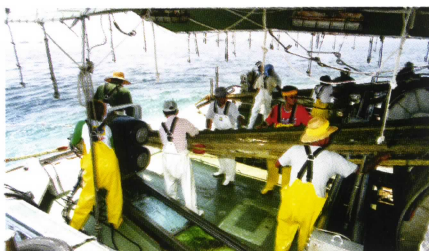
④ 荒手網、手腰網は二股に分かれているので、網船2隻がそれぞれネットローラーで巻き取ります。
