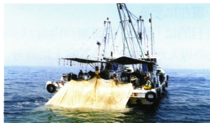
⑤ ラッパ口までくるとネットローラーを止め、ボールローラーや人力で揚げます。
