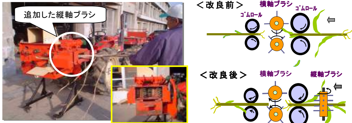
図 1 改良脱葉機の外観と脱葉方式
