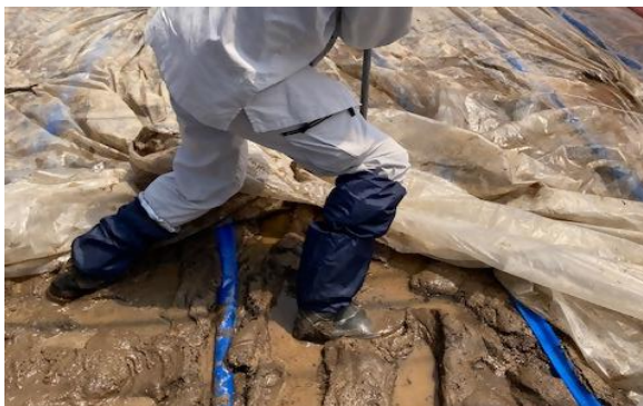
⑦棒を差し込み土壌水分状況の確認
