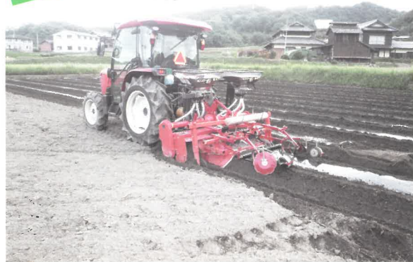
直進アシスト機能付きトラクターによる同時施肥、耕起、畝立て成型、マルチングの様子
