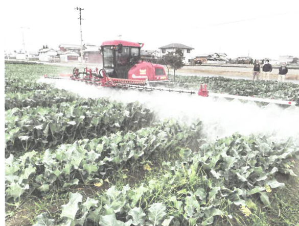
GNSS自動操舵乗用型防除機での防除の様子
