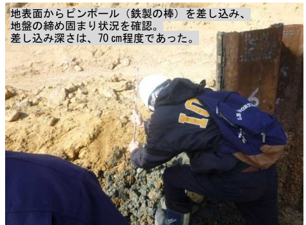
写真IV-10 引抜き跡の確認（締め固まり状況）
