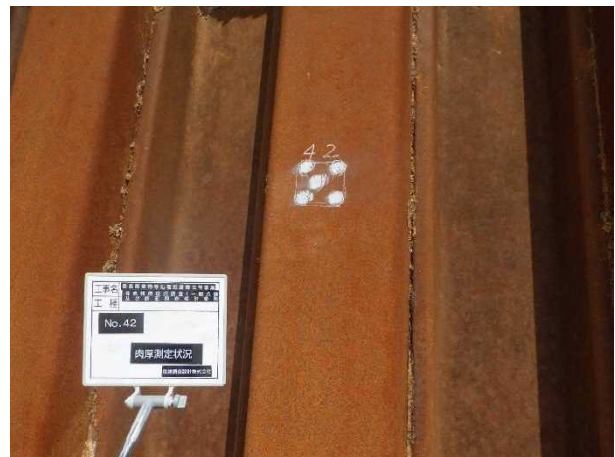
写真 6 肉厚測定箇所-研磨後 (No. 42)
