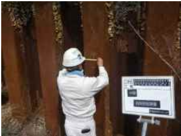
写真3 肉厚測定箇所-研磨前 (中間)
