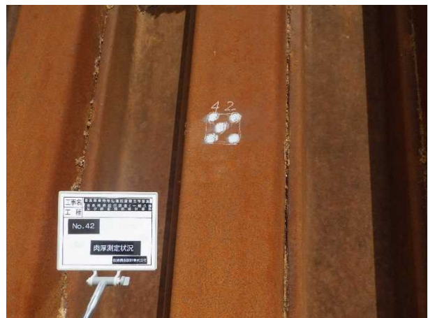
写真 6 肉厚測定箇所-研磨後 (No. 42)
