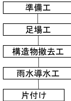
図1 施工手順の概要
