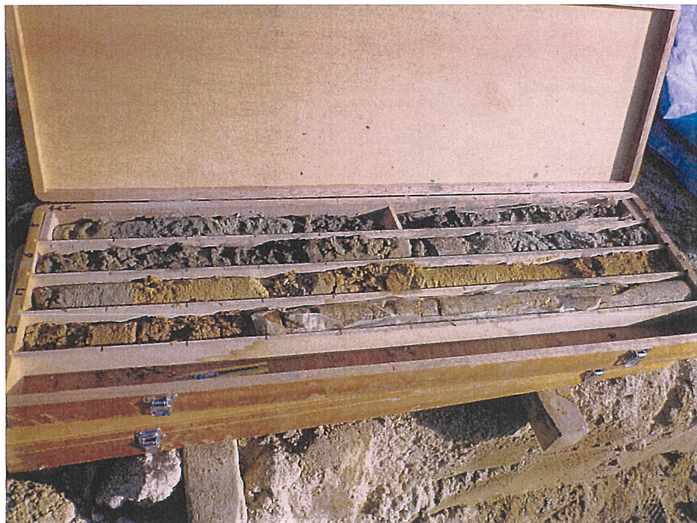
写真8 観測井 No. 2 ボーリングコア (深度 5.0~9.0m)
