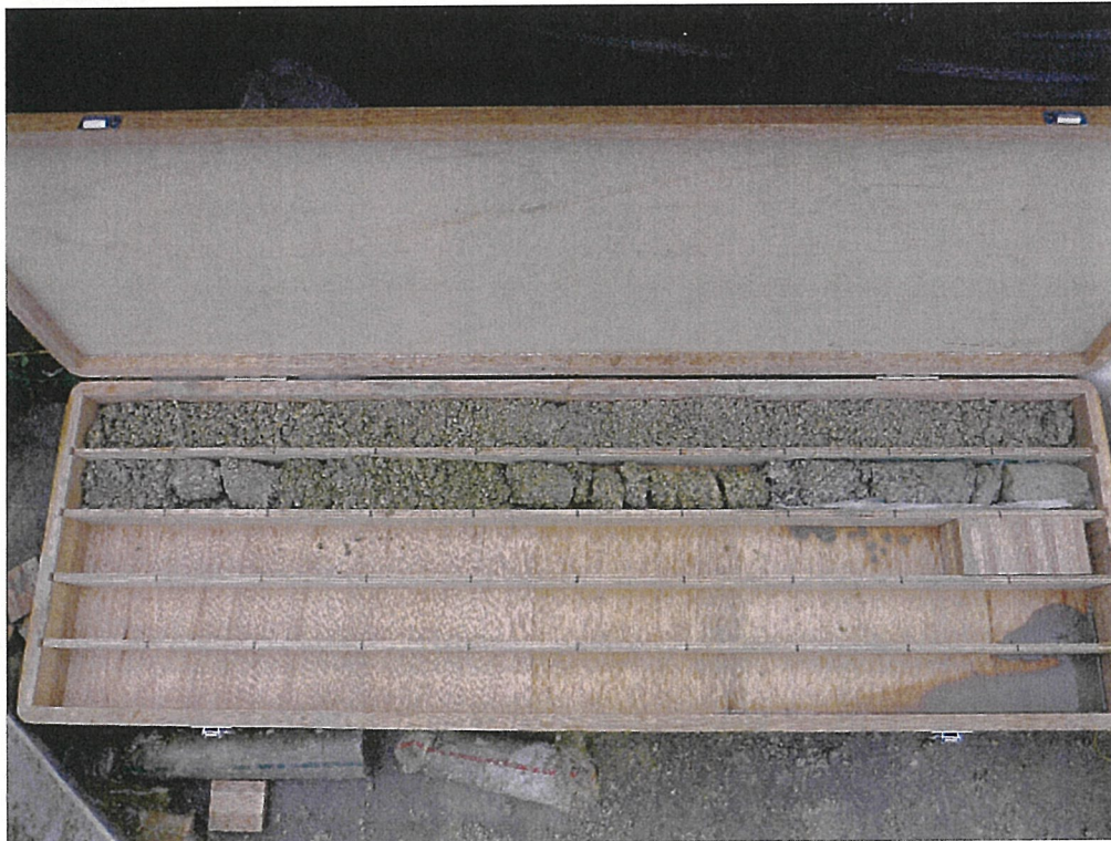
写真6 観測井 No. 1 ボーリングコア (深度 5.0~7.0m)
