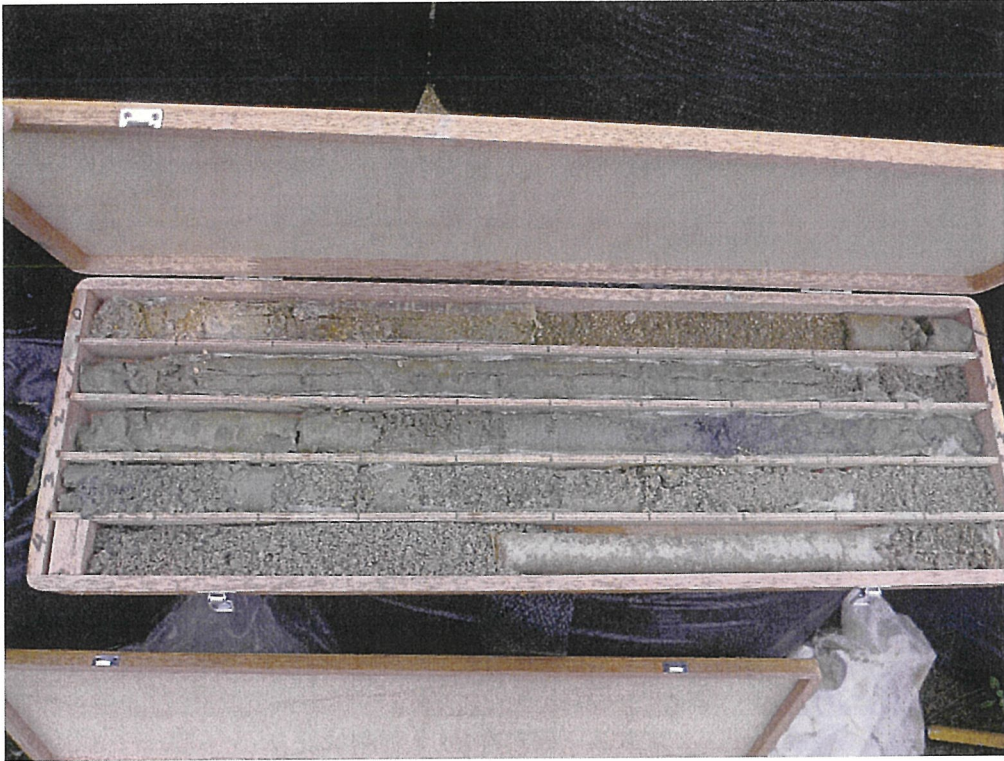
写真5 観測井 No. 1 ボーリングコア (深度 0.0~5.0m)
