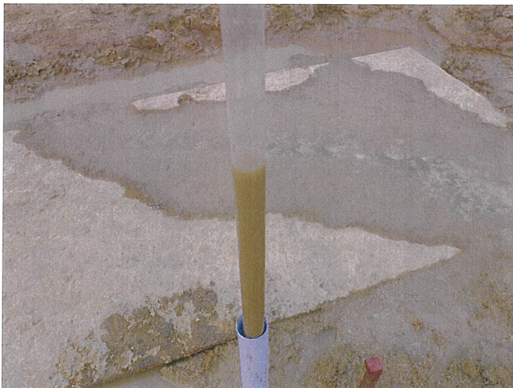
写真10 観測井 No. 2 中間層地下水
