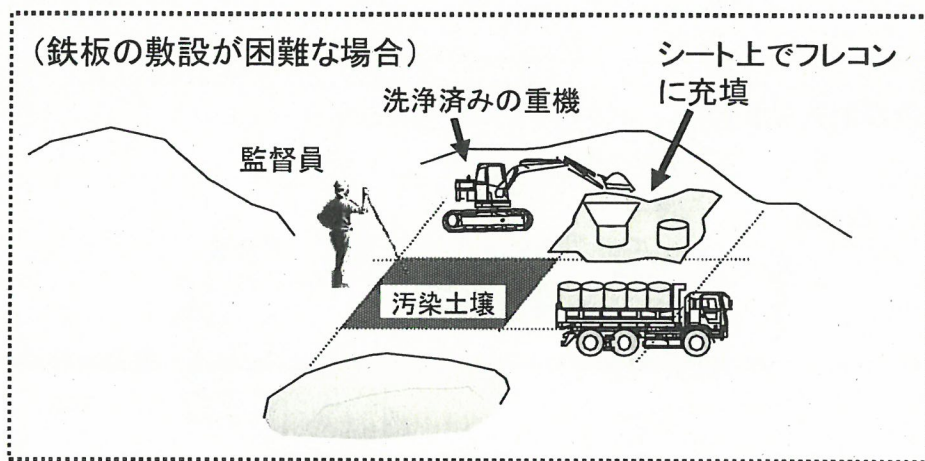
図2 廃棄物層直下汚染土壌の掘削・除去イメージ (揮発性有機化合物が完了判定基準を超過した場合)
