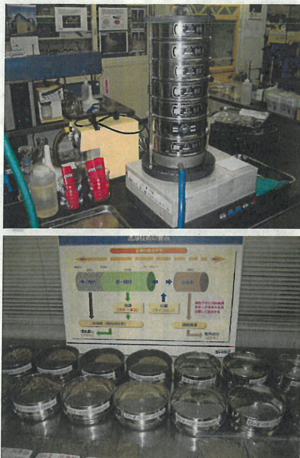
写真-3 粒度分布試験で使用した湿式振動フルイと金網フルイ
