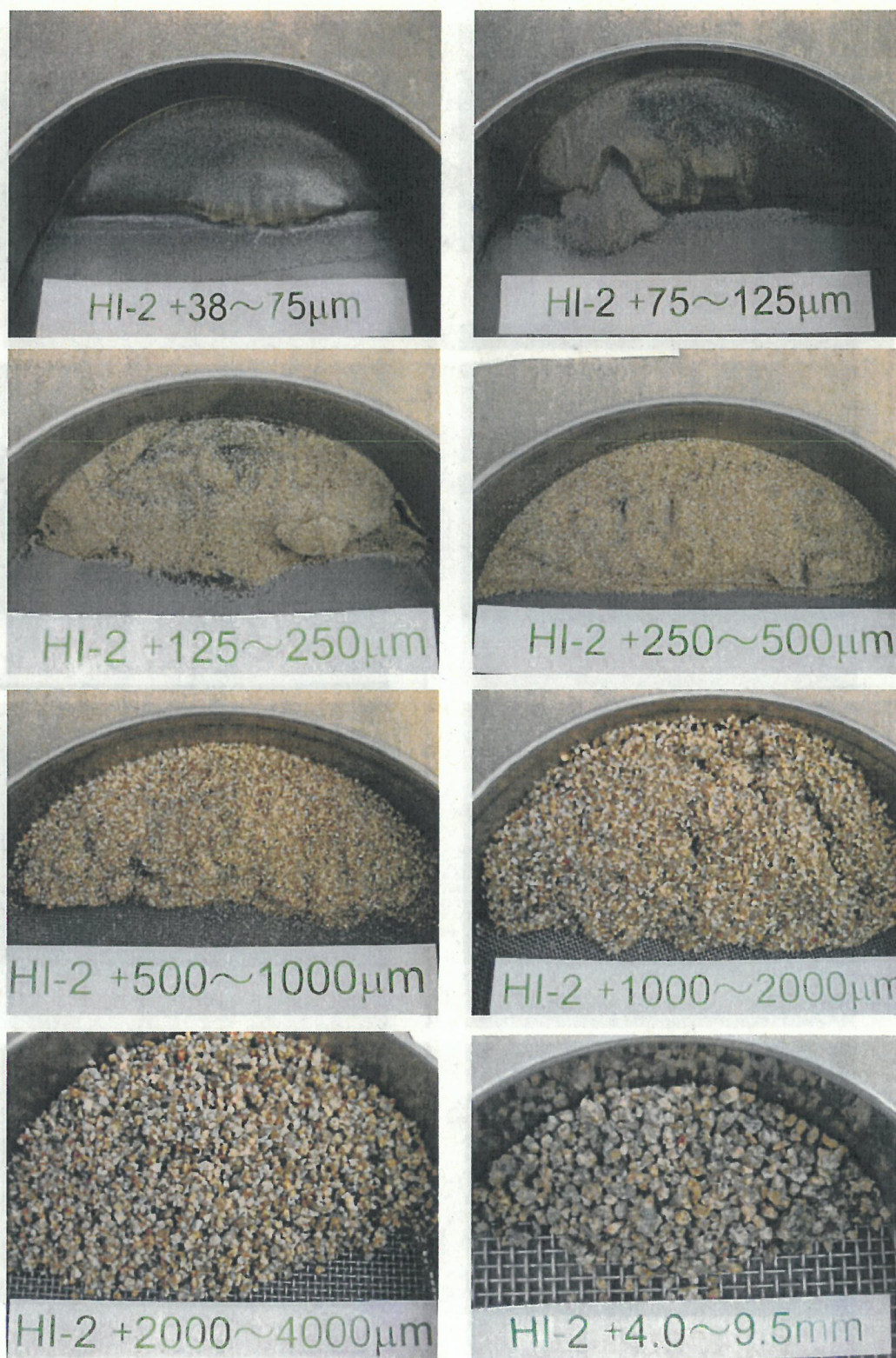
写真-4(C) HI-2土壌試料の粒度分布試験, 38 \mu m~9.5mmの分級試料
