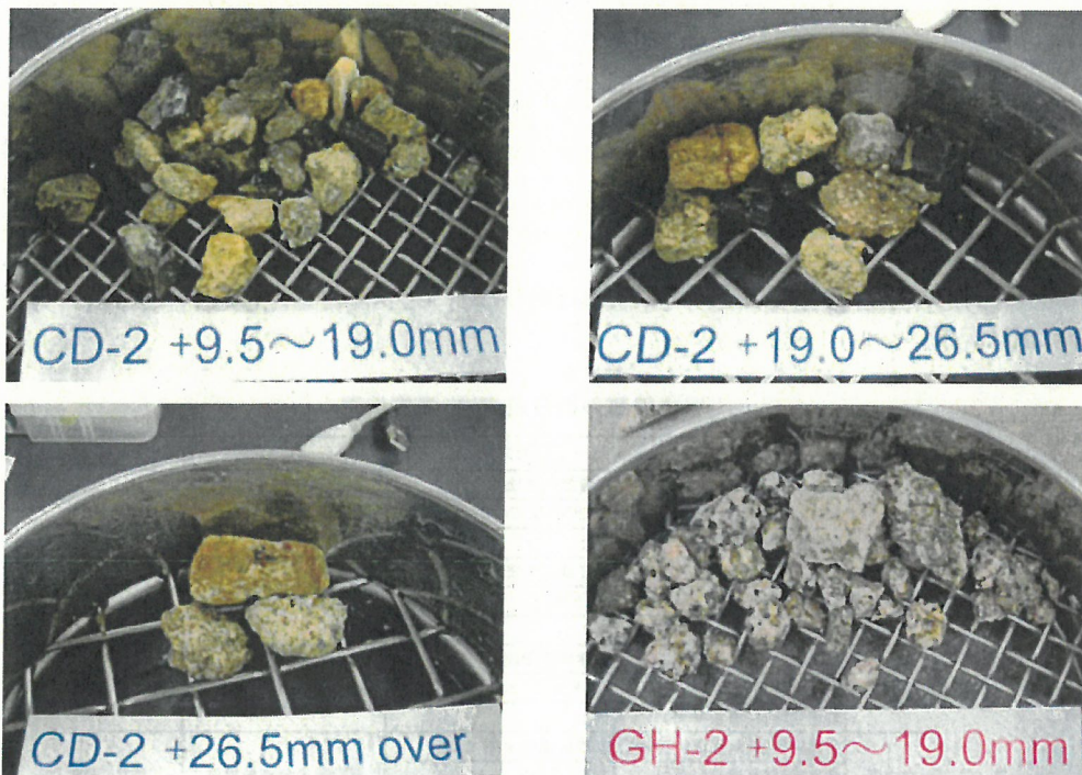
写真-2 CD-2, GH-2 土壤試料の 9.5mm 以上の粗粒子分(砂利, 礫)の外観
