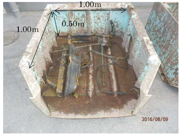
写真 26 撤去された埋設金属物 (洗浄後)
