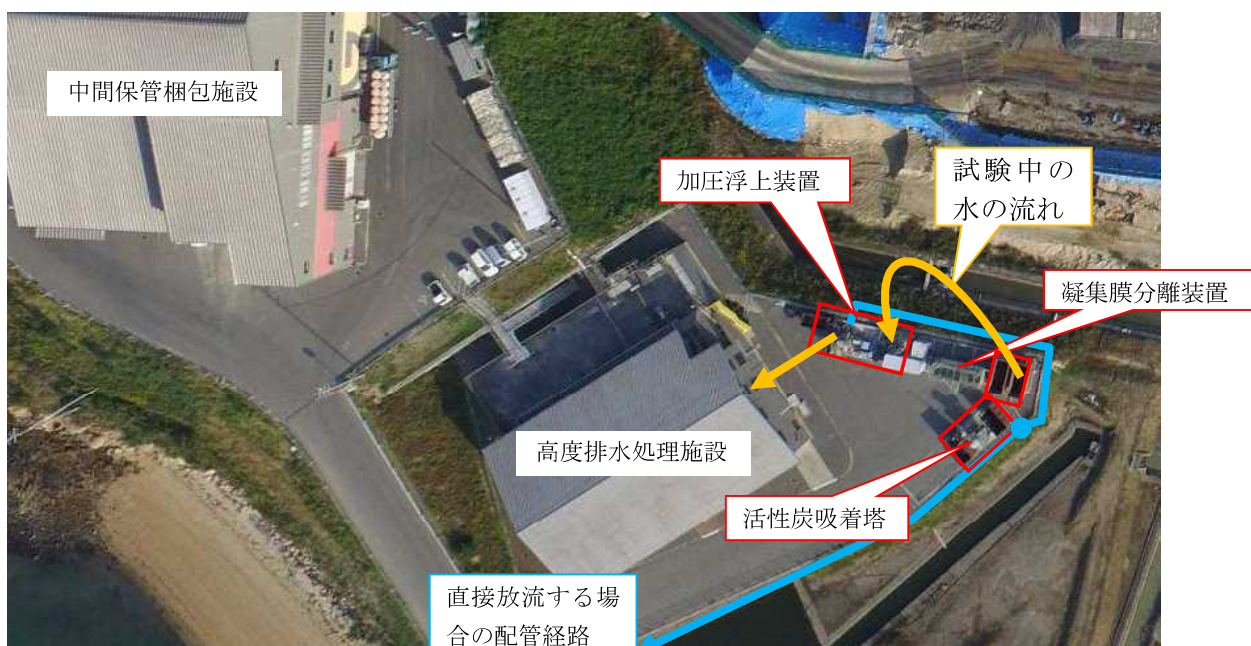
図 貯留トレンチ貯留水導水経路
