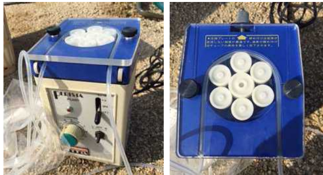
写真 1 ペリスタリックポンプ
