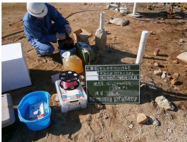
フィールドポンプによる採水状況
