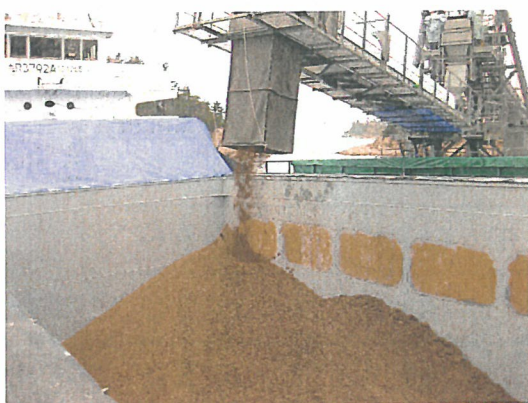
ベルトコンベアでの輸送船への積込み
