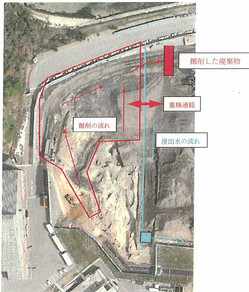
図3 底面掘削手順
