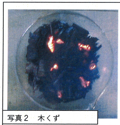
350°C 加熱・空気吹付け着火試験の写真
