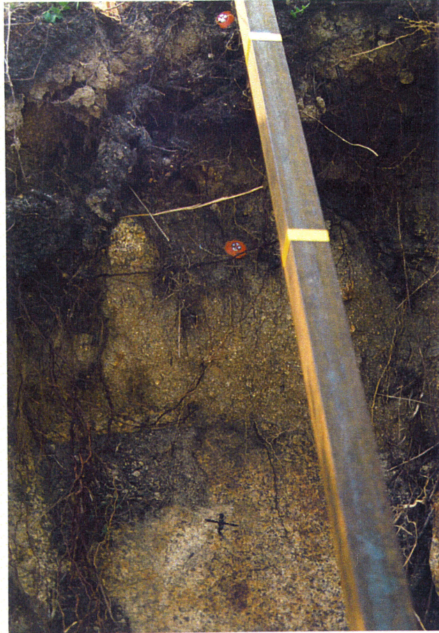
簡易変位計設置状況
