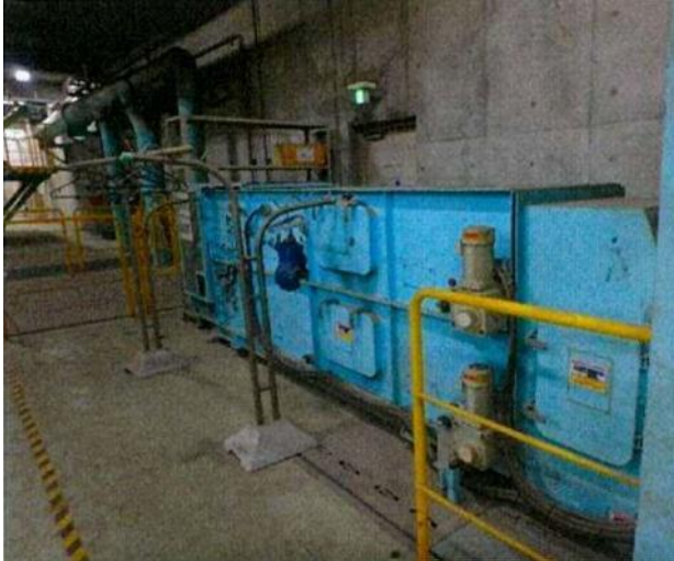
除去・除染作業前 (漁業産業廃棄物処理装置外観を撮影)
