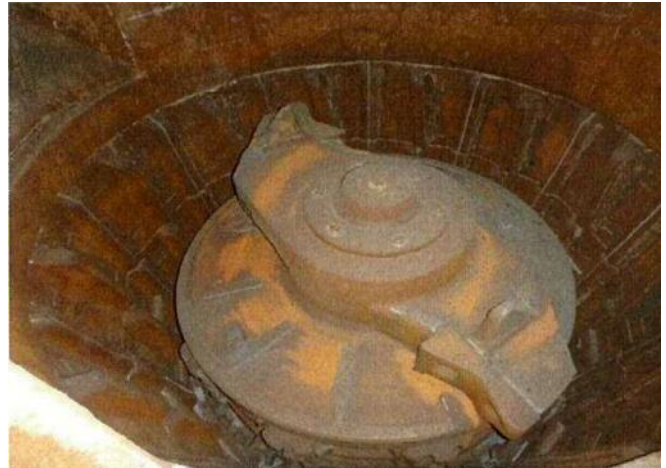
除去・除染作業前 (上から破碎機内部を撮影)
