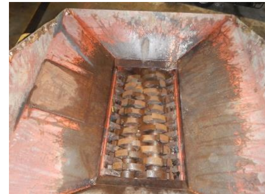
二軸破碎机除去・除染作業後
