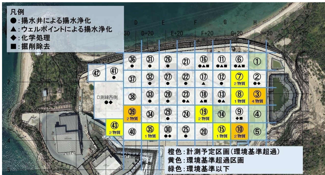
図1 各区画における浄化対策の種別と13区画のうちの環境基準超過の汚染物質数
