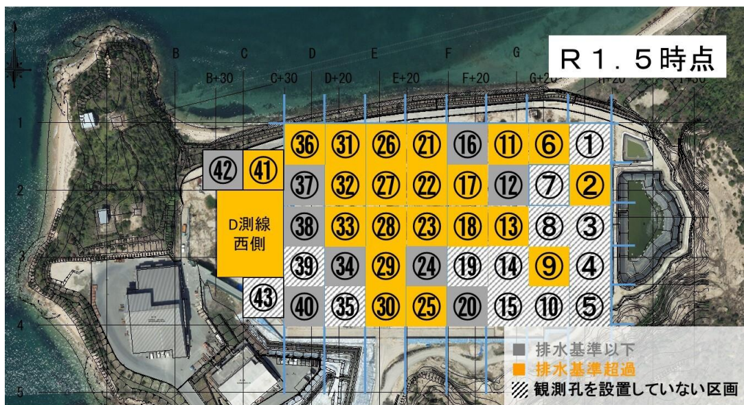
図3-5-1 処分地全域での地下水の状況 (令和元年5月時点)
