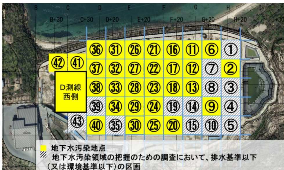
図4-1-1 地下水汚染地点の位置（到達・達成マニュアルに基づく）
