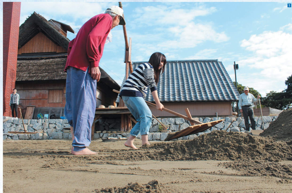
1 お話を聞く前にまず塩田作業を体験。「浜引き」と呼ばれるこの工程では、馬鍬(まぐわ)で砂浜の表面に凹凸を作り、そこへ海水をひしゃくで散布する 2 太陽熱で水分を蒸発させ、乾いた砂を沼井(ぬい)と呼ばれる抽出装置に入れ、海水をかけて塩分を溶かす作業 3 1と2の作業を繰り返し、ようやくかん水(高濃度の塩水)ができる。これを煮詰めて結晶化させ、ようやく塩ができあがる 4 塩づくりを指導してくれた柏原さん。小柄なお体で簡単そうに道具を操るが、いざやってみると相当な重労働だ 5 復元塩田の全景。中央の盛り上がったところが沼井
