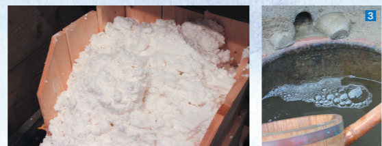
1 お話を聞く前にまず塩田作業を体験。「浜引き」と呼ばれるこの工程では、馬鍬(まぐわ)で砂浜の表面に凹凸を作り、そこへ海水をひしゃくで散布する 2 太陽熱で水分を蒸発させ、乾いた砂を沼井(ぬい)と呼ばれる抽出装置に入れ、海水をかけて塩分を溶かす作業 3 1と2の作業を繰り返し、ようやくかん水(高濃度の塩水)ができる。これを煮詰めて結晶化させ、ようやく塩ができあがる 4 塩づくりを指導してくれた柏原さん。小柄なお体で簡単そうに道具を操るが、いざやってみると相当な重労働だ 5 復元塩田の全景。中央の盛り上がったところが沼井
