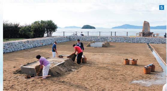
1 お話を聞く前にまず塩田作業を体験。「浜引き」と呼ばれるこの工程では、馬鍬(まぐわ)で砂浜の表面に凹凸を作り、そこへ海水をひしゃくで散布する 2 太陽熱で水分を蒸発させ、乾いた砂を沼井(ぬい)と呼ばれる抽出装置に入れ、海水をかけて塩分を溶かす作業 3 1と2の作業を繰り返し、ようやくかん水(高濃度の塩水)ができる。これを煮詰めて結晶化させ、ようやく塩ができあがる 4 塩づくりを指導してくれた柏原さん。小柄なお体で簡単そうに道具を操るが、いざやってみると相当な重労働だ 5 復元塩田の全景。中央の盛り上がったところが沼井
