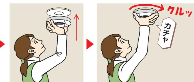
住宅用火災警報器に付いている取り付け板を附属のネジ等で天井又は壁に取り付けます。電池式であれば、設置・交換の際に資格は必要ありません。
