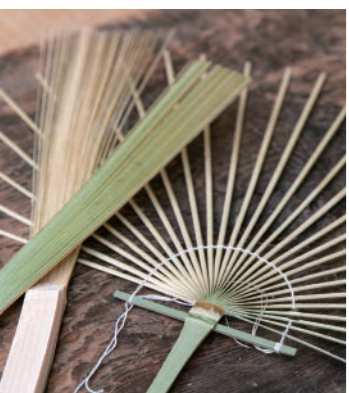
国の伝統的工芸品である「丸亀うちわ」には47もの工程がある。写真はうちわの骨をつくる「割り」の工程。「切込機」を使い、同じ間隔で32~42本に裂いていく。
