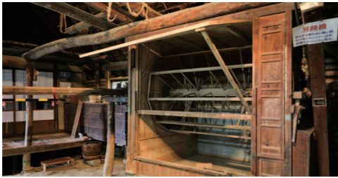
「ガンド」と呼ばれるふるい機は、筒状に並んだ棒の周囲に網布を貼って使う。筒の内側まで運ばれた粉を回転しながらふるい落とす。
